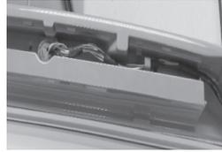
18. Utilice la llave de 11 mm para separar el eje de la bisagra superior. Dé la vuelta a la bisagra superior y vuelva a montar el eje de la bisagra superior.
