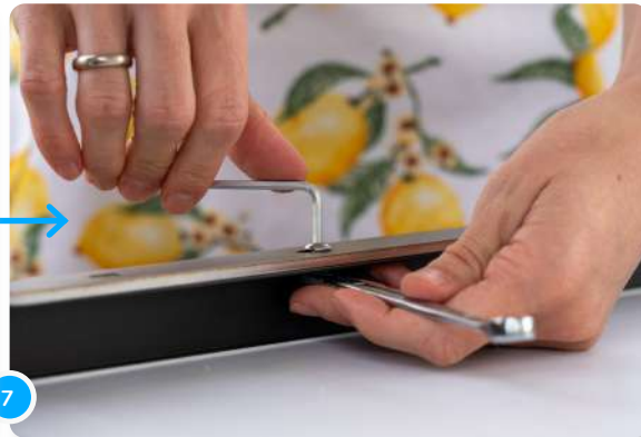
7 Ahora puedes fijar los dos soportes con cuatro tornillos y tuercas cada uno.
